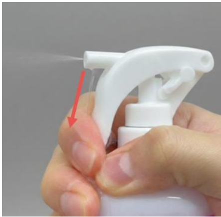
下方向の亀裂の場合：液だれ
