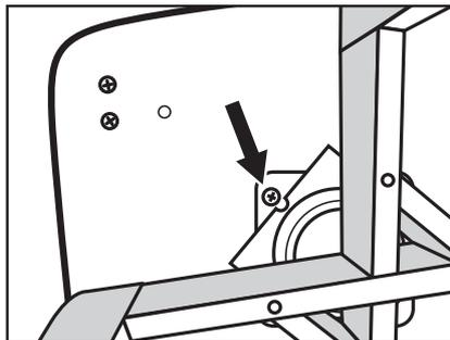
一本のネジを一度に強く締めずに、ゆるんでいる場所のネジを順番に少しずつ何回かに分けて締めてください。締めすぎると、本体が破損する恐れがありますのでご注意ください。
